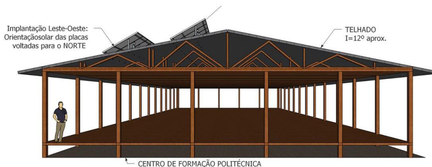
Figura 6: Ângulo de inclinação dos painéis = Maior mínimo mensal (30°N) em relação ao plano horizontal
