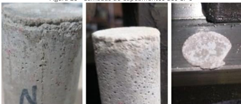
Figura 20– Camadas de Capeamentos dos CP's
