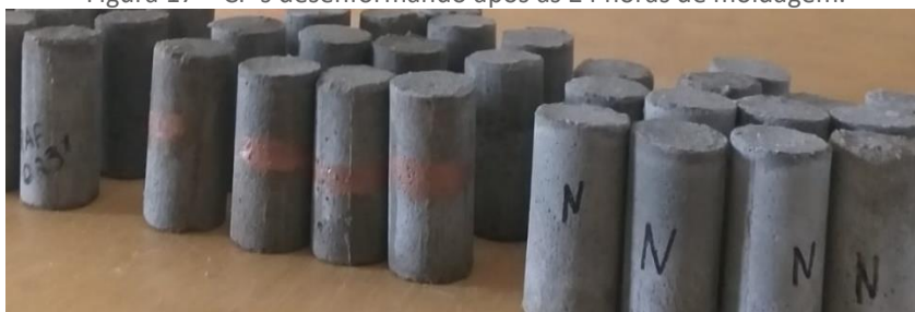
Figura 17 – CP's desenformando após as 24 horas de moldagem.
