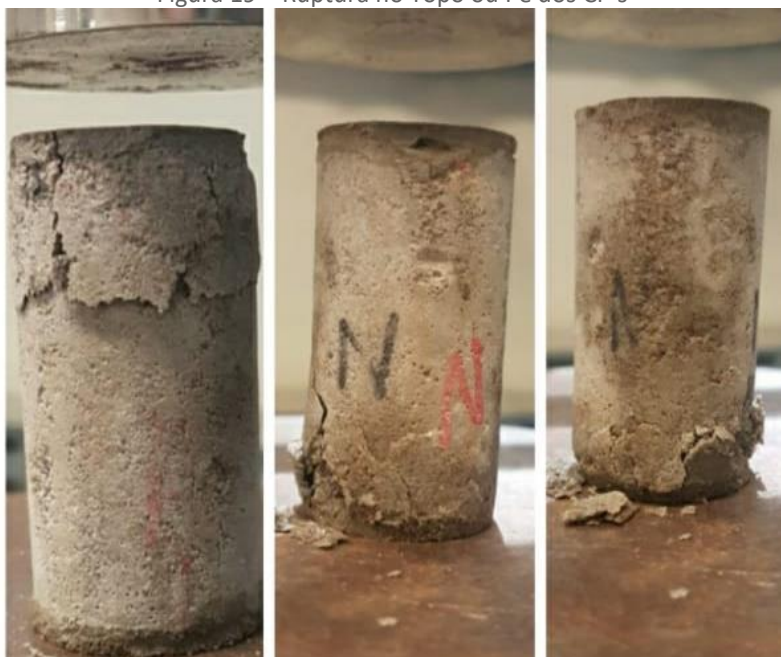
Figura 19 – Ruptura no Topo ou Pé dos CP's
