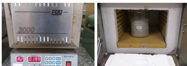
Figura 13 – Tratamento Térmico/ Processo de Redução de GO em Cimento.
