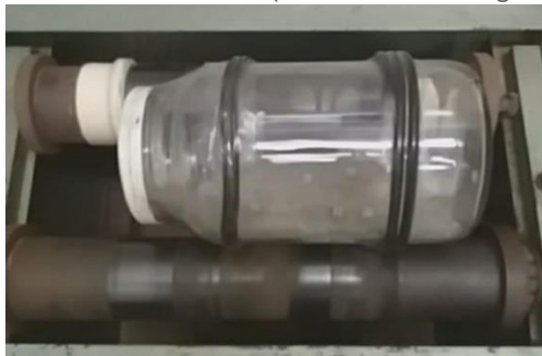
Figura 12 – Moinho Mecânico (Processo de homogeneização).
