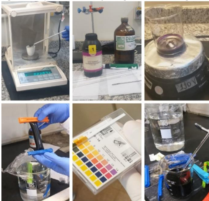
Figura 2 – Etapas de transformação do grafite em óxido de grafeno.
