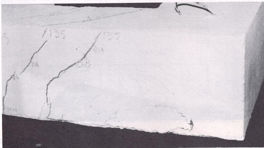
**Figura 14: Detalhe da fissuração junto aos apoios, para um carregamento próximo à carga de ruptura.**
