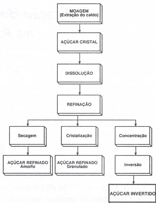
FIGURA 2. Fluxograma simplificado da produção industrial de açúcar invertido.
