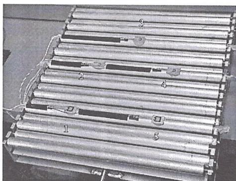
Os sensores empregados foram os resistores sensíveis à força (FSR - Force Sensing Resistor), de dimensões aproximadas 15 x 15 mm (Interlink Electronics, 1999). Esses sensores são delgados dispositivos de filme
