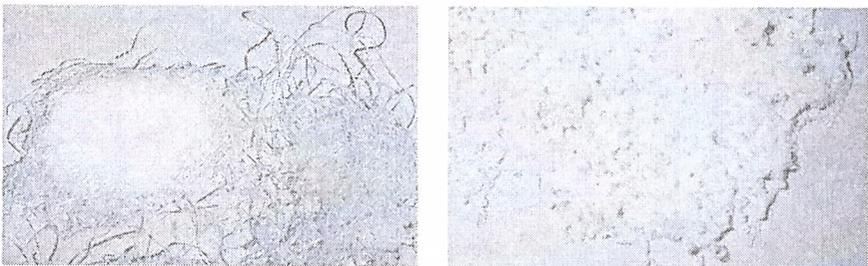
**FIGURA 8 – Cavaco formado no torneamento com a ferramenta “DCGX11T308 AL” para o avanço 0,025 mm/volta e 0,050 mm/volta.**
