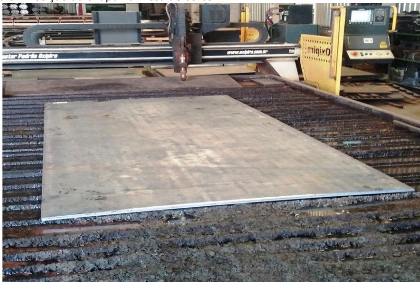
Figura 6 – Posição da chapa na mesa de corte
