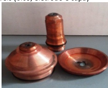
Figura 13 – Conjunto de consumíveis (bico, eletrodo e capa)
