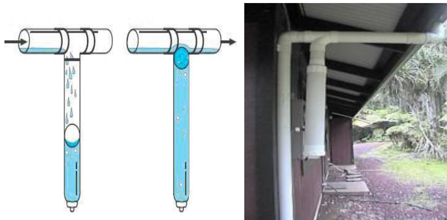
Figura 5 – Sistema Australiano Para Descarte do First Flush
