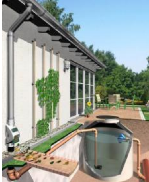
Figura 7 – Filtro Para Águas Pluviais Instalado No Tubo De Descida
