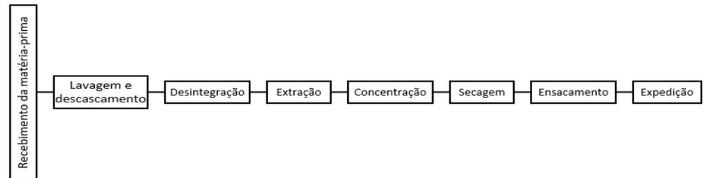
A etapa de limpeza das raízes de mandioca é realizada mecanicamente por um lavador-descascador. Após essa etapa as mandiocas são classificadas manualmente para a retirada de raízes com característica indesejadas e segue para a trituração. Na etapa de trituração, as mandiocas passam por um picador cilíndrico que fragmentam e padronizam a matéria-prima, permitindo maior eficiência nas etapas seguintes.
