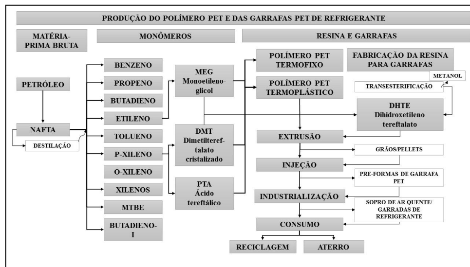
Figura 1: Diagrama de produção do polímero e das garrafas PET.
