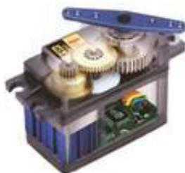
Figura 5 - Servo motor
