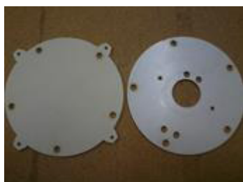
(b) Partes da base do manipulador. Base principal à direita e sobre-base à esquerda
