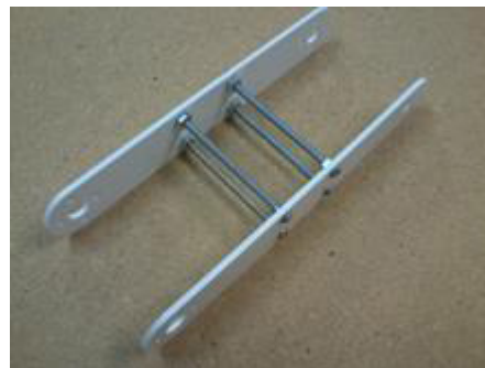
(c) Braço montado sem os motores de passo
