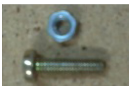
(a) Parafuso de dimensões 2cm * 3mm, e porca de 3mm
