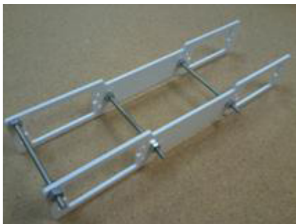
(b) Antebraço montado sem os motores de passo
