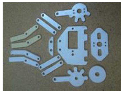
(b) Partes da garra do manipulador
