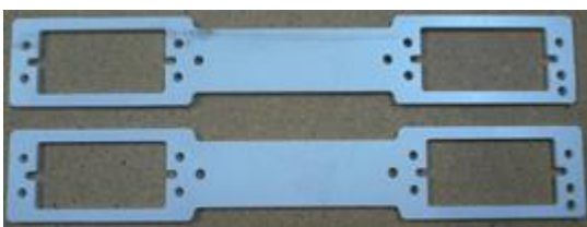
(a) Partes do antebraço do manipulador
