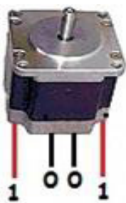
(a) Esquema alternância de pulso, grupo vermelho em true e grupo preto em false
