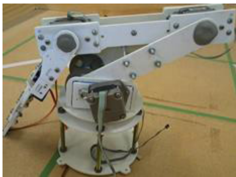
(a) Parte lateral do manipulador com os ajustes de epóxi
