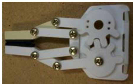
(c) Garra montada, esperando os motores para finalizar o manipulador
