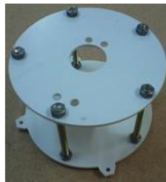
(c) Base montada sem os motores de passo
