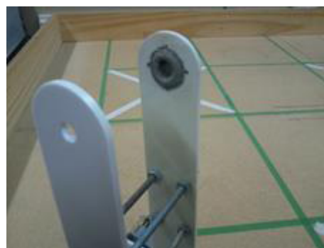
(b) Região do braço com o encaixe de Epóxi
