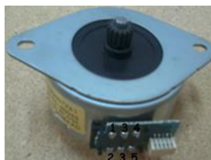
Figura 10 - Motor de passo com 5 fios utilizado na base do manipulador construído
