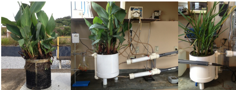
Figura 3- Amostra indeformada plantada com Canna x generalis retirada do leito (esquerda) e respirômetro montado com amostra de Canna x generalis (centro) e Typha latifolia (direita)
