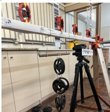
Figura 3 – Barra exposta a carga de 6Kg
