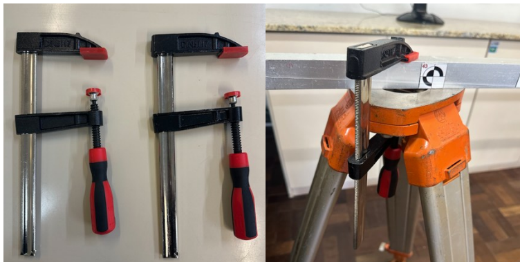
Figura 2 – Grampos de utilizados para fixar a barra aos tripés
