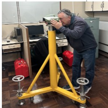
Figura 4 – Nível DNA03 sendo operacionalizado, instalado sobre tripé industrial
