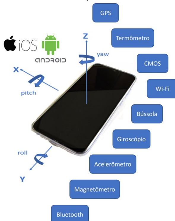
Figura 4 – Sistemas operacionais, movimentos da plataforma e múltiplos sensores dos smartphones
