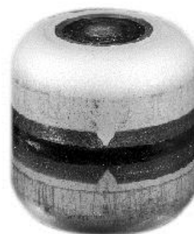
Figura 2 - Pastilha de combustível de Pu^{238} em seu revestimento protetor de irídio
