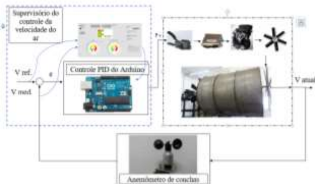
Fig. 04 – Supervisão e controle implementado no túnel de vento.
