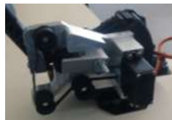
Figura 03 – Servo motor, polias, correia dentada e o acelerador.
