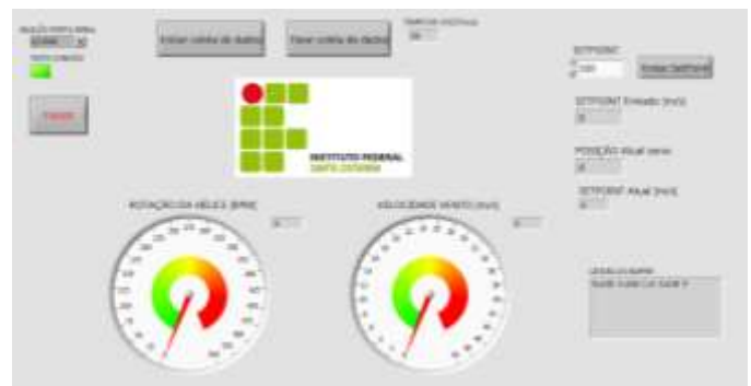
Fig. 06 – Tela de supervisão criado no Labview ® .
