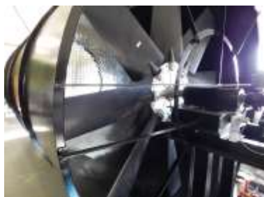
Figura 02 – Vista a montante da hélice do túnel de vento
