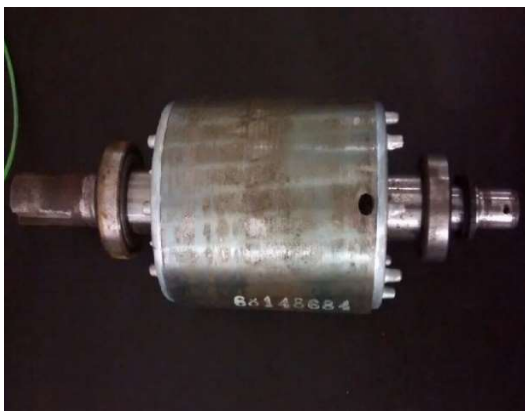
Fig. 8. Rotor com a simulação da falha de barra quebrada
