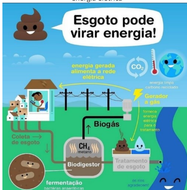
Figura 1 - Imagem indicativa do processo de reaproveitamento do esgoto para geração de energia elétrica
