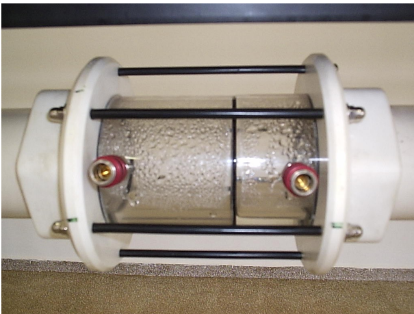
Figura 2: Placa de Orifício
