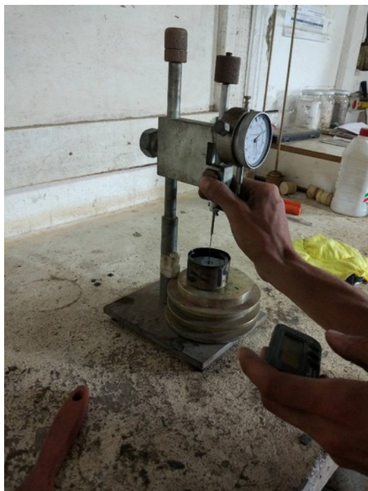
Figura 3 – Penetrômetro para CAP
