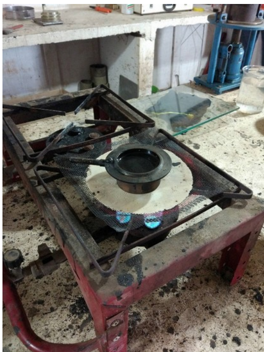
Figura 5 – Amostra sendo aquecida para ensaio de ponto de fulgor
