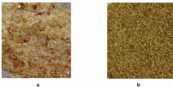
Figura 01 – Aspecto Visual do Bagaço de Maçã: (a) Bagaço Úmido (b) Bagaço Seco na Granulometria 0,25 mm.
