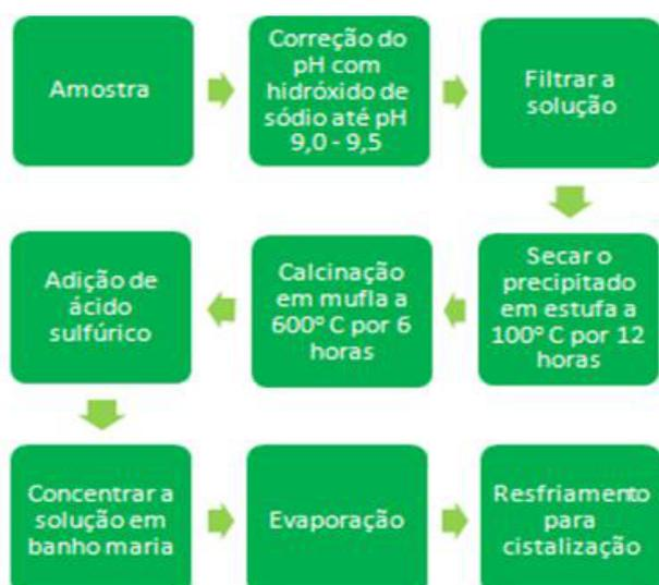
Figura 01 – Fluxograma do tratamento de cobre.
