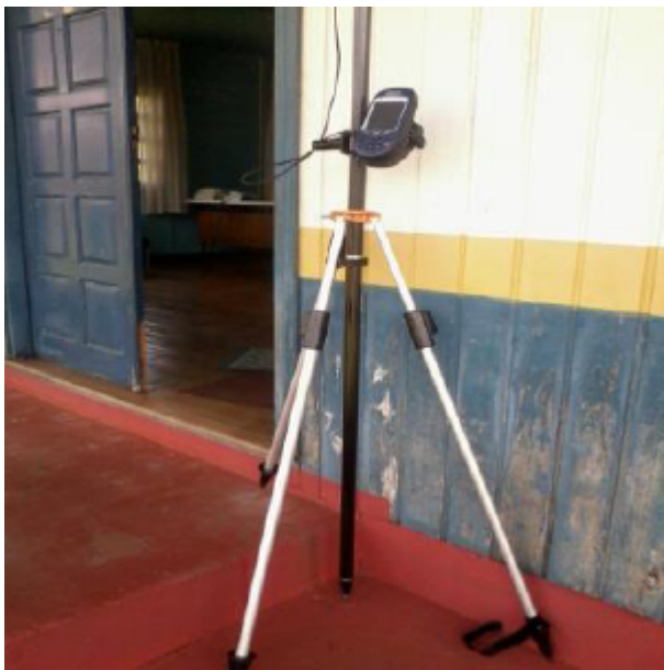
Figura 1: GPS ASHTECH, utilizado nos levantamentos para obtenção da altitude geométrica das RRNN.
