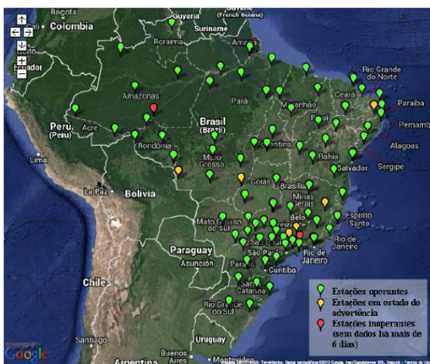
Figura 3 - Estações da Rede Brasileira de Monitoramento Contínuo dos Sistemas GNSS. Fonte: www.ibge.com .
