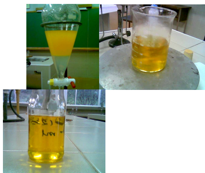
Figura 3 - Da esquerda para direita, lavagem, secagem em placa de aquecimento e biodiesel pronto.
