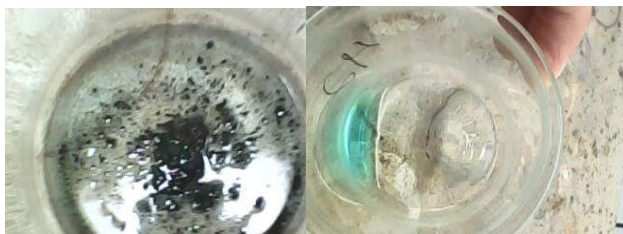
Figura 5 – Formação do sulfato de cobre pentahidratado. Fonte: DALPASQUALE, M.
