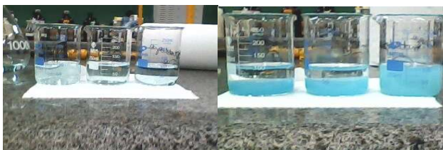
Figura 3 – À Esquerda: solução padrão de cobre. À Direita: solução após a adição de hidróxido de sódio. Fonte: DALPASQUALE, M.
