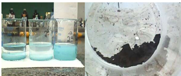
Figura 4 – Formação do óxido de cobre, à esquerda no início da formação e a direita com o término da reação. Fonte: DALPASQUALE, M.
