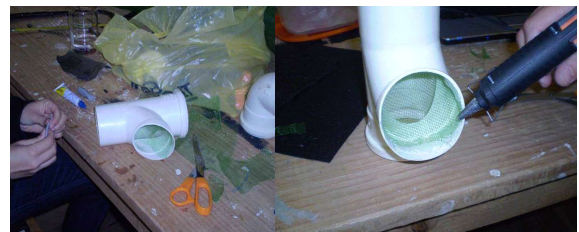
Figura 4: Preparação junção PVC para confecção do filtro e colagem da tela mosquiteira.
