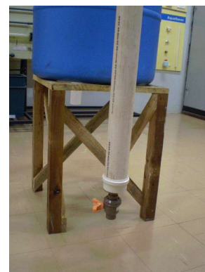
Figura 6: Reservatório tem porão da primeira água da chuva e regulador da quantidade de descarte da primeira água de chuva
