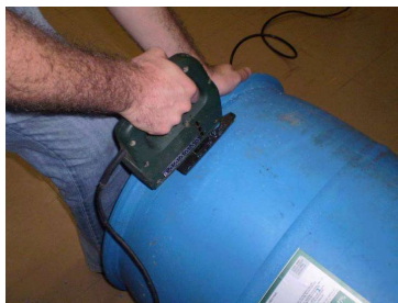
Figura 2: A abertura parte superior da bombona.
