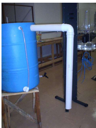
Figura 14: Extravasador ou saída para uma nova cisterna.
