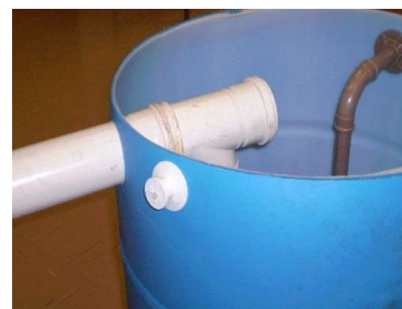
Figura 12: Plug fixado para prender o sistema clorador.
