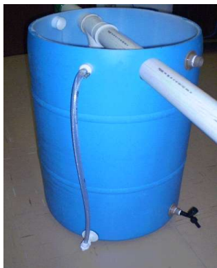
Figura 13: Mangueira para visualização do nível da água na cisterna.
