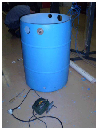
Figura 3: A abertura para o posicionamento da tubulação de 75 mm
