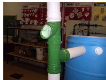
Figura 5: Junção do filtro de descarte e tê para desvio da água da primeira chuva.
