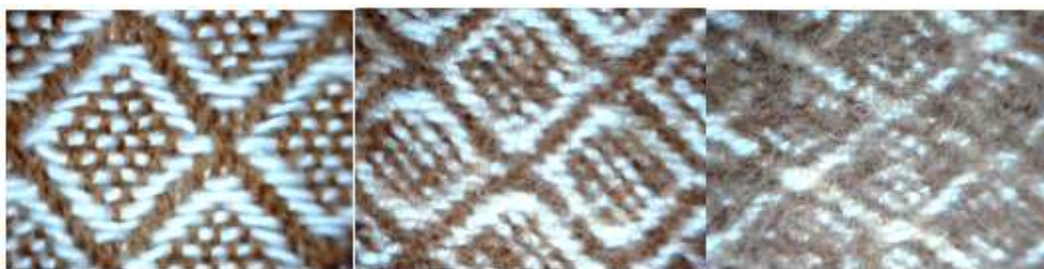
Figura 18 - Experimento 5: o tecido na versão crua e após cem minutos e cento e cinquenta minutos de batanagem, ampliado vinte e cinco vezes. Fonte: Autora.
