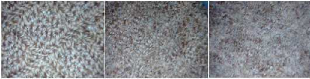
Figura 14 - Experimento 1: o tecido na versão crua e após cem minutos e cento e cinquenta minutos de batanagem, ampliado vinte e cinco vezes. Fonte: Autora.
