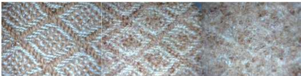
Figura 17 - Experimento 4: o tecido na versão crua e após cem minutos e cento e cinquenta minutos de batanagem, ampliado vinte e cinco vezes. Fonte: Autora.
