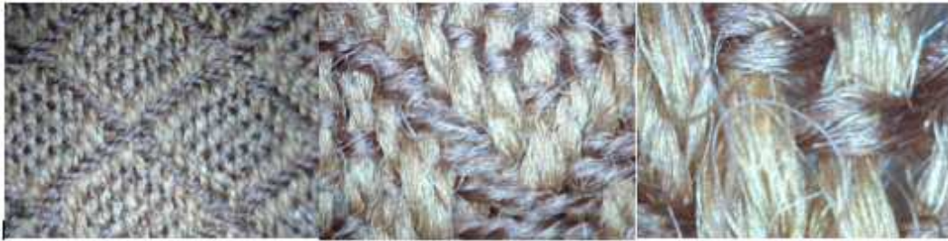
Figura 10 - Experimento 3: fios grossos de lã no urdume e fios mais finos na trama, ambos de mesma cor. Fonte: Autora.
