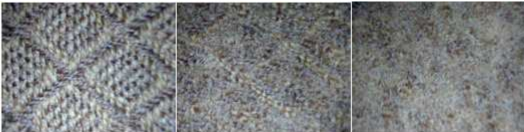
Figura 16 - Experimento 3: o tecido na versão crua e após cem minutos e cento e cinquenta minutos de batanagem, ampliado vinte e cinco vezes. Fonte: Autora.
