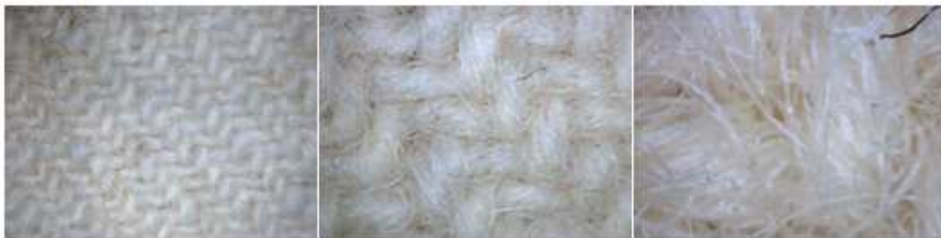
Figura 13 – Exemplo do burel original, em ampliações de 25, 60 e 210 vezes. Fonte: Autora.
